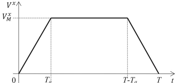
Figure 9 - Loi de commande de vitesse en trapèze
