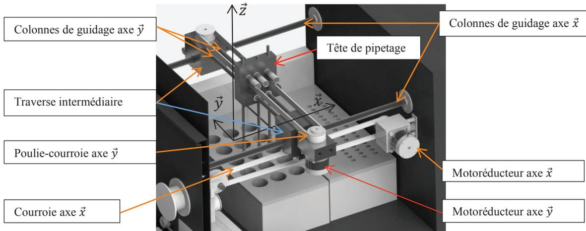
Figure 7 - Système de guidage suivant  $\vec{x}$  et  $\vec{y}$
