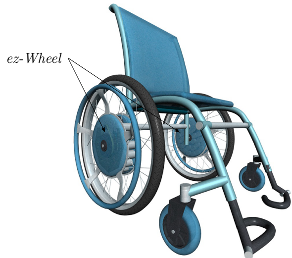
Figure 3 – Prototype de fauteuil roulant équipé de deux ez-Wheel
