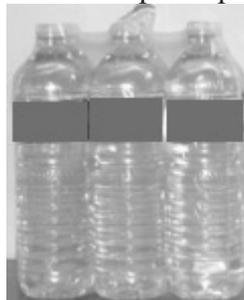
Le procédé de fardelage présente l'avantage de s'adapter à tous les formats et permet un emballage jusqu'à 6 faces. Plusieurs techniques peuvent être utilisées pour réaliser l'opération de fardelage. Celle proposée dans cette étude consiste à déposer un film plastique thermo-rétractable puis à le chauffer pour qu'il épouse la forme du produit à emballer.
