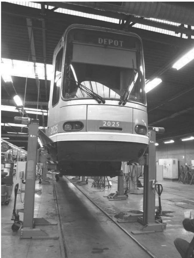
**Photo 5 : Tramway en position soulevée**
