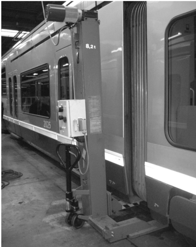
Photo 3 : Mise en place d'une colonne
