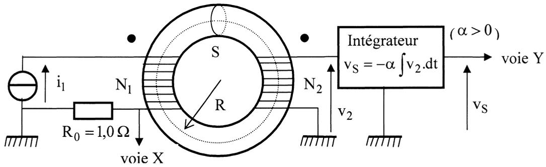
Dans les conditions expérimentales,  $N_2 \cdot i_2 \ll N_1 \cdot i_1$ . On ne tiendra pas compte de la résistance des enroulements.  $H$  et  $B$  sont supposés uniformes dans le tore.
