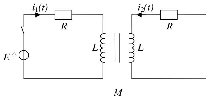
8.1/ En utilisant la loi des mailles, écrire les deux équations différentielles couplées vérifiées par  $i_1(t)$  et  $i_2(t)$  lorsque l'interrupteur est fermé.
