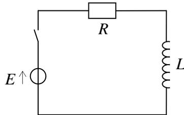
L'intensité  $i(t)$  est initialement nulle pour  $t < 0$ . A l'instant  $t = 0$ , l'interrupteur est fermé.
