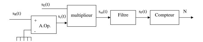
On rappelle qu'un multiplieur attaqué par deux signaux  $s_1(t)$  et  $s_2(t)$  délivre un signal  $s_m(t) = k*s_1(t)*s_2(t)$  où k est une constante multiplicative égale à  $0.1 \text{ V}^{-1}$ .
