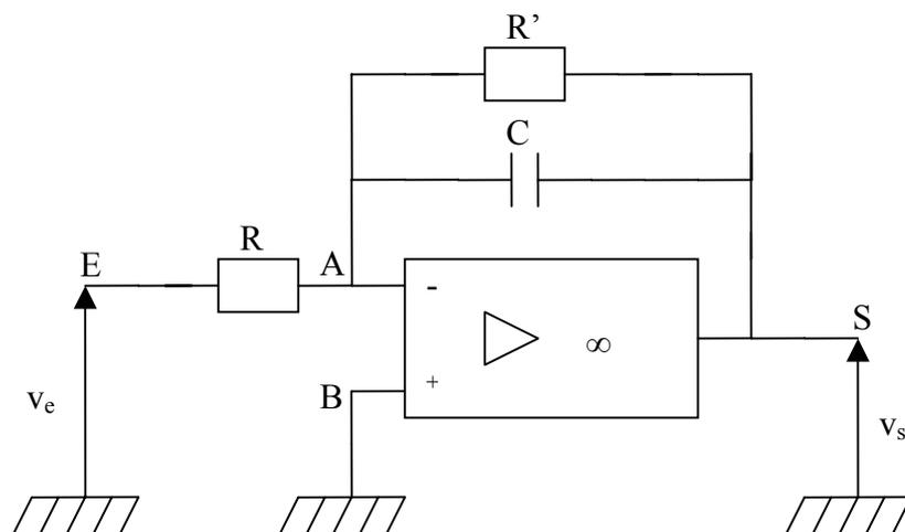
11/ Déterminer l'équation différentielle (1) vérifiée par  $v_s(t)$  en fonction de  $v_e(t)$ ,  $R$ ,  $R'$  et  $C$ .
