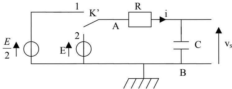
A la date  $t = 0$ , le condensateur étant déchargé, on ferme l'interrupteur  $K'$  dans la position 1 (phase 1). Lorsque la charge sous la tension  $\frac{E}{2}$  est terminée, on bascule  $K'$  dans la position 2 (phase 2) et on procède à la charge du condensateur sous la tension  $E$ .
