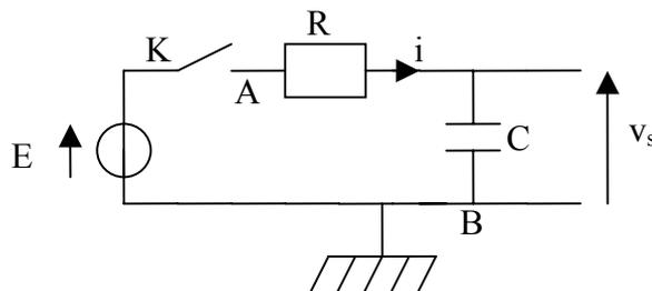
1/ Quel est le comportement du condensateur au bout d'un temps très long (infini) après la fermeture de l'interrupteur ? En déduire les valeurs correspondantes de  $v_s$  et de l'intensité  $i$  dans le circuit au bout d'un temps très long.
