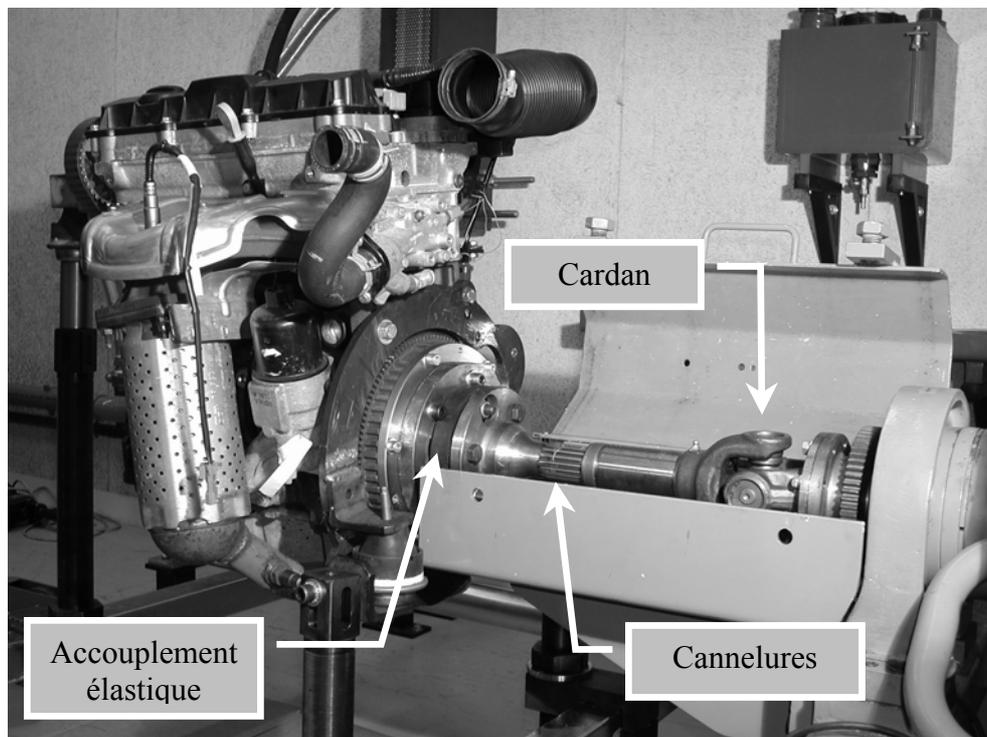
**Photo 3 : Transmission entre le frein et le moteur**
