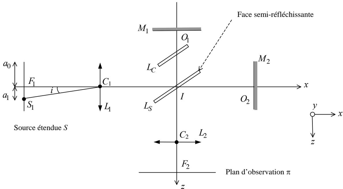
L'interféromètre comporte une lame  $L_S$ , de centre  $I$ , semi-réfléchissante, non absorbante, appelée séparatrice, dont le facteur de réflexion énergétique  $R$  vaut  $R = 0,5$ . Cette lame est inclinée à  $45^\circ$  par rapport aux normales à  $M_1$  et  $M_2$ .
